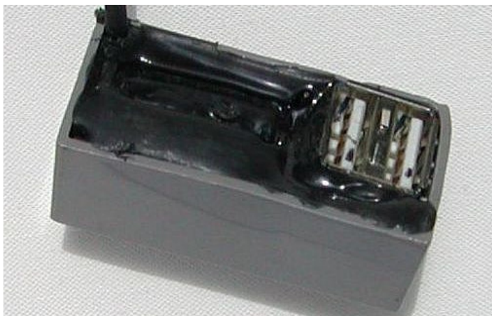
Bild 6: Der vergossene und einsatzbereite Minimallader ist kleiner als eine Streichholzschachtel
